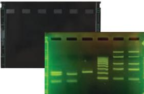
A utiliser pour la séparation de l'ADN. Plaque de plastique de couleur noire imprimée avec une règle vert fluorescent sur le bord, texture sur la zone du puits
