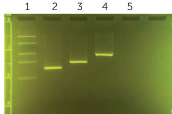
Exemple de résultats du kit de validation du système PCR ~ 20 min. d'amplification et ~ 15 min. de migration
