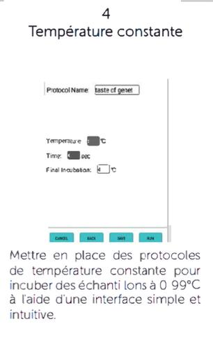
Mettez en place des protocoles de température constante pour incuber des échantillons à 0-99°C à l'aide d'une interface simple et intuitive.
