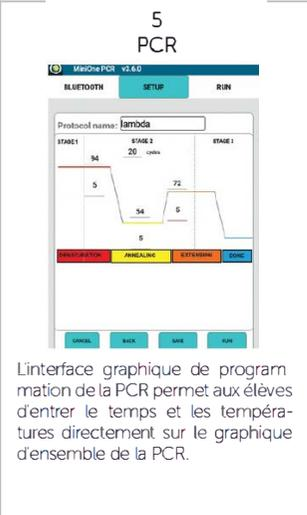
L'interface graphique de programmation de la PCR permet aux élèves d'entrer le temps et les températures directement sur le graphique d'ensemble de la PCR.
