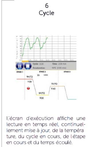
L'écran d'exécution affiche une lecture en temps réel, continuellement mise à jour, de la température, du cycle en cours, de l'étape en cours et du temps écoulé.
