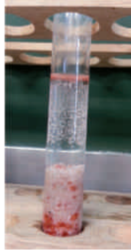
La paraffine est remontée à la surface de l'eau
