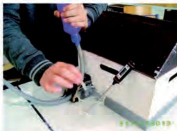
3. L'eau chauffée remonte dans le tuyau à l'aide d'une pompe (bouteille en plastique). Un thermomètre indique la température à la sortie du tuyau.
